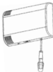
Il faut dégrafer le capot du socle avec un tournevis à tête plate.
