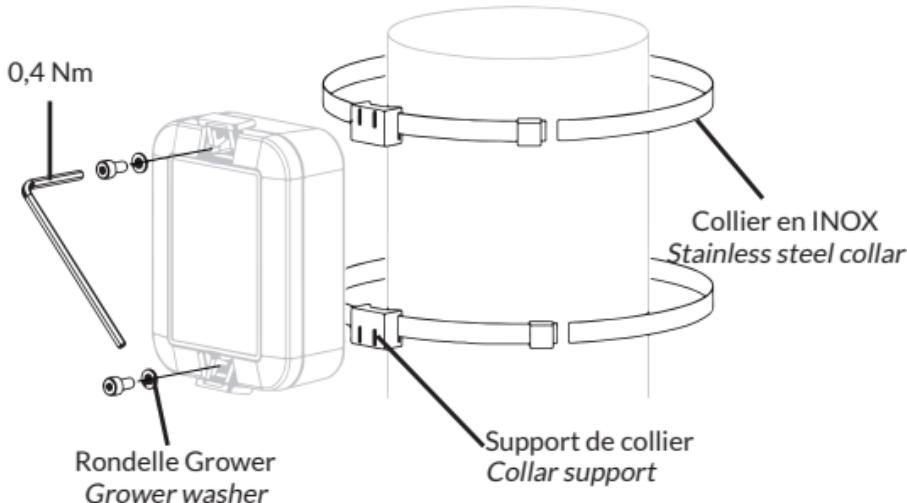
Pivoter les 2 petits capots du boîtier afin de visser les supports de collier au boîtier, en insérant la rondelle Grower sous la tête de vis
