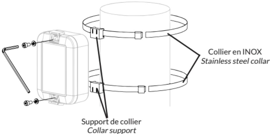
Ouvrir les 2 petits capots du boîtier afin de visser les supports de collier au boîtier, en insérant la rondelle Grower sous la tête de vis
