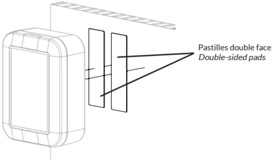
Nettoyer les surfaces à encoller à l'aide de la lingette 3M fournie avec le capteur.
