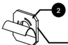
Déclipper l'embase du capteur optique. Retirer le film de protection de l'embase seule. Ne pas salir le double-face.
