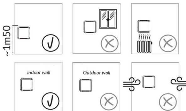
Le Capteur est fixé dans la pièce dont la mesure de température est la plus représentative du bâtiment, de la zone.
