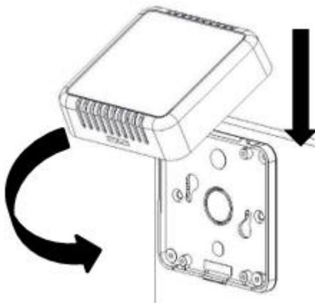
Nota : dans le cas de support avec risque d'amiante, il est possible de coller le Capteur à l'aide de deux bandes « mousse adhésive double faces » de type 3M 9529 ou 3M VHB 4945 (bandes non fournies).
