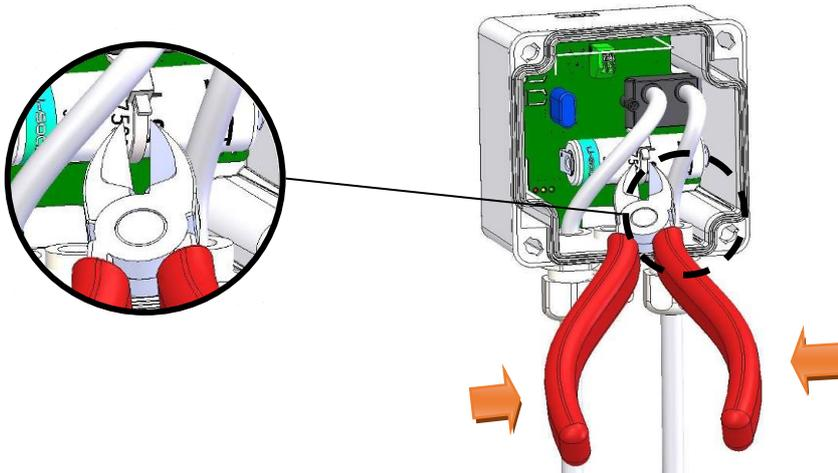
Retirer la pile usagée des supports et remplacer par une pile 3.6V Lithium LS17500 SAFT 3600mAh
