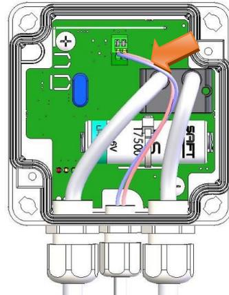
Replacer le couvercle puis à l'aide d'un tournevis à tête plate, tourner les vis d'un quart de tour dans le sens horaire, pour les verrouiller. Veiller à ne pas pincer les tubes à l'intérieur du boîtier.
