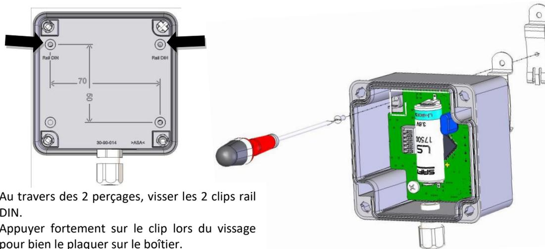
Pour le déclipsage sur le rail DIN, glisser un tournevis dans le trou d'un des clips et exercer un effort de haut vers le bas tout en éloignant le boîtier du rail DIN. Idem pour le deuxième clip.
