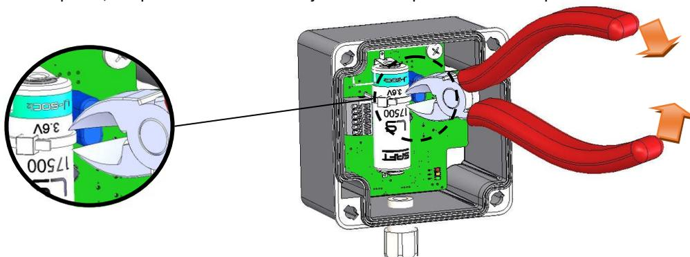
Retirer la pile usagée des supports et remplacer par une pile 3.6V Lithium LS17500 SAFT 3600mAh
